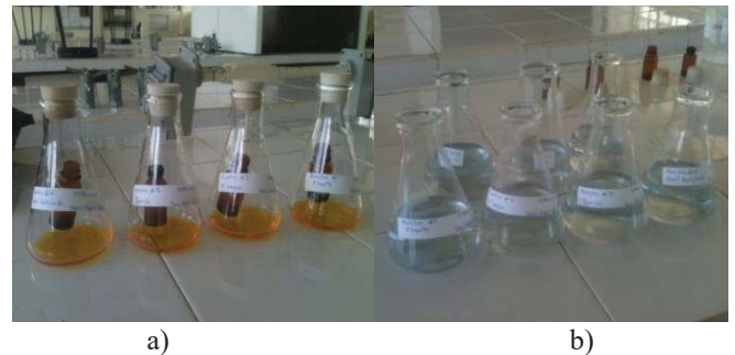
Fig. 7. Determinación de etanol en solución acuosa. a) preparación de muestras. b) valoración final de la muestra con Na_2S_2O_3 .
