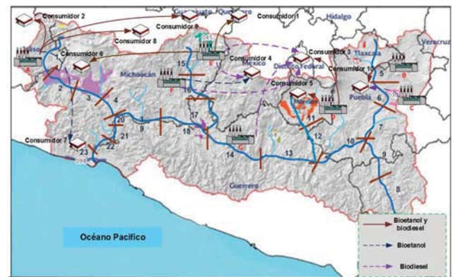
Fig. 1. Distribución óptima del sistema de biorefinerías obtenida para el caso de estudio propuesto.
