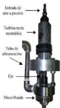
Figura 2. Atomizador de disco rotatorio.
