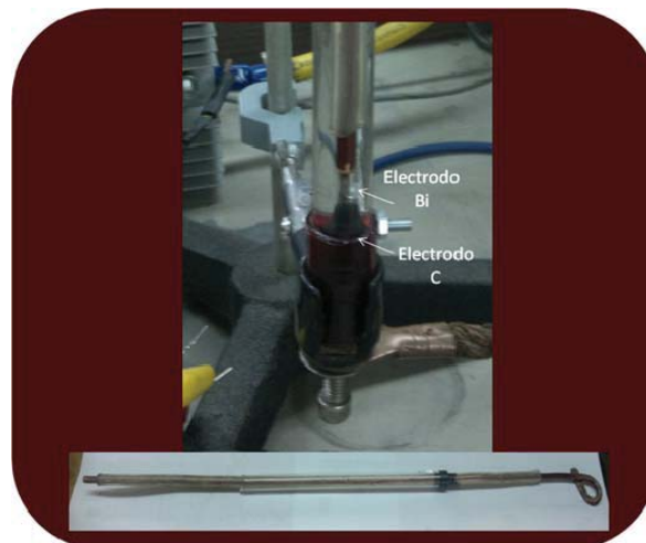
Fig. 2. Electrodo centrado dentro de tubo de vidrio.
