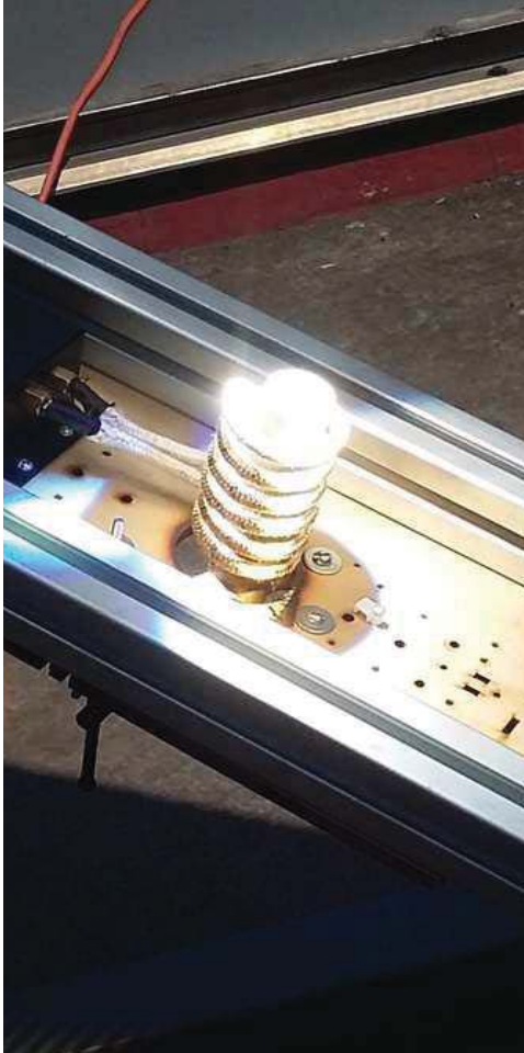
Fig. 10. Imagen de un sistema híbrido calentamiento por inducción-calentamiento mediante ESC para el procesamiento de materiales. Facultad de Ingeniería UNAM [16]
