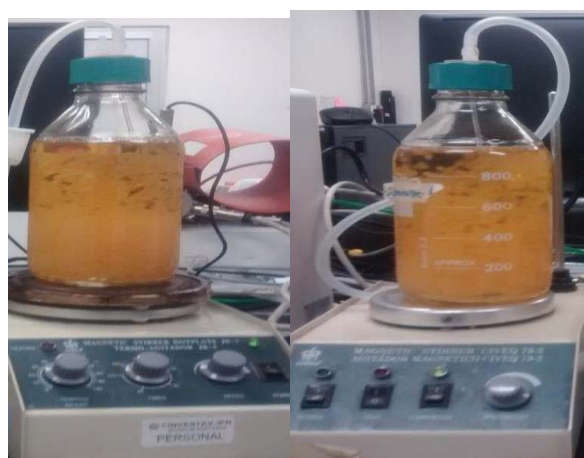
Figura 1 Configuración de frascos agitados mecánica y neumáticamente.
