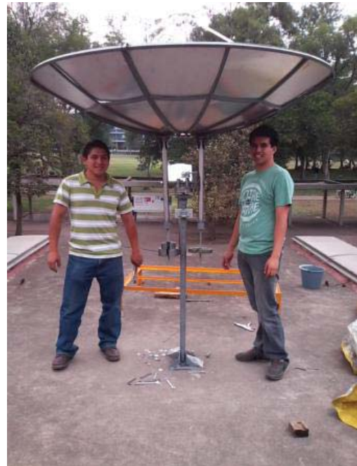
Fig. 19. Concentrador parabólico construido en la Facultad de Ingeniería de la UNAM con su correspondiente sistema de seguimiento solar
