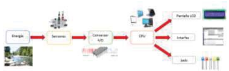
Figura 6. Proceso de detección y adquisición de datos.
