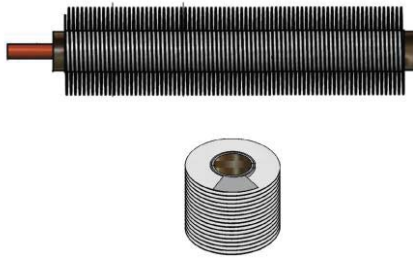
Fig. 2 Termostifón de aletas empotradas
